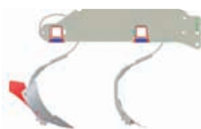
Подпружиненный окучивающий корпус 5 с подпружиненными плоскими лапами (жесткий монтаж к раме) 5
