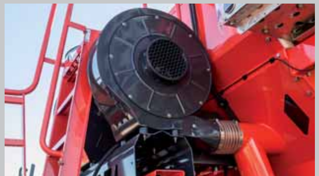
Два удобных в обслуживании высокомощных вентилятора для непрерывной транспортировки удобрений
