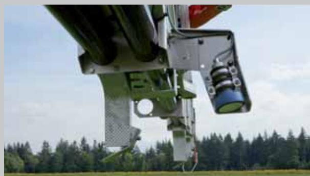
Distance Control: ультразвуковой датчик
