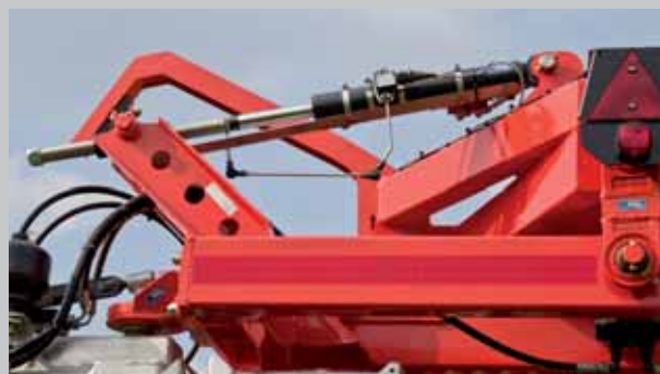
Distance Control: автоматическое управление штангой
