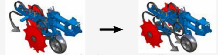
3 или 5 зубцов типа стрелчатой лапы 32x10 мм или 32x12 мм с 150-мм лемехом
