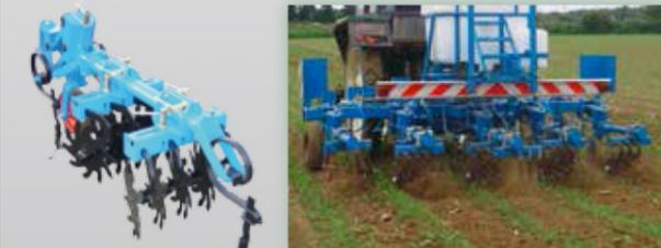
Диски Ø 370 мм до 10 зубцов с расстоянием 135 мм
