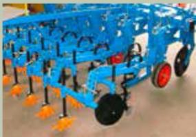
Устанавливаемые на заднюю часть элемента рыхлительные звездочки Ø 360 мм для ширины междурядья от 60 см до 1м
