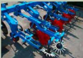
Устанавливаемые на заднюю часть элемента на S-образном креплении рыхлительные звездочки Ø 360 мм для ширины междурядья от 45 см до 80 см
